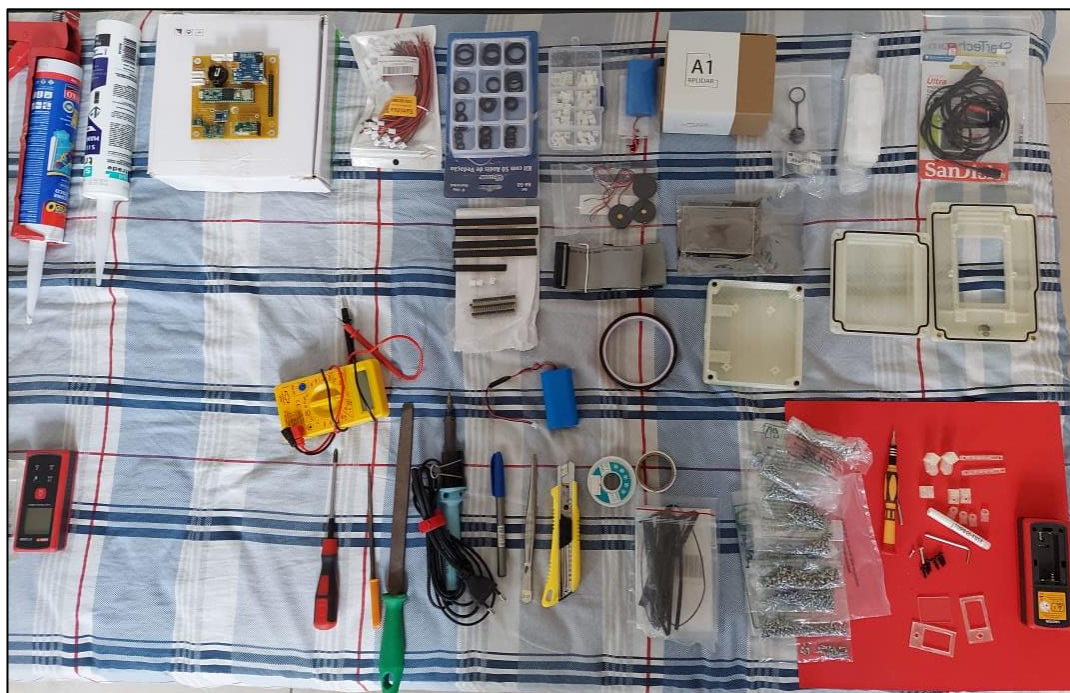
Figura 8 – Rol de componentes e acessórios prontos para a montagem definitiva. Placa mãe com principais componentes com as soldas já realizadas.
