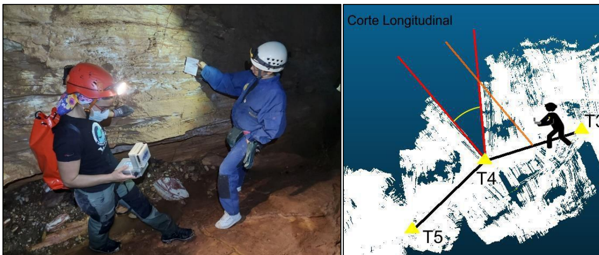
Figura 25 – Gruta Volks Clube. A) Uso do Caveatron e do cartão refletivo na base de destino. B) “Vazio” de varredura ocasionado pela diferença angular no desnível entre bases. Para prevenir o erro é necessário realizar a sobreposição, iniciando a varredura metros antes. Fonte: EGB, 2022.
