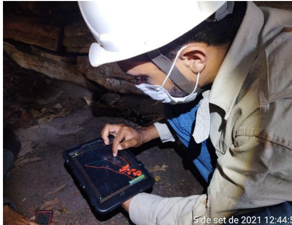
Figura 4 – Croqui digital da caverna sendo realizado no tablet, conectado às medidas realizadas pelo Disto X. Fonte: elaborado pelos autores.
